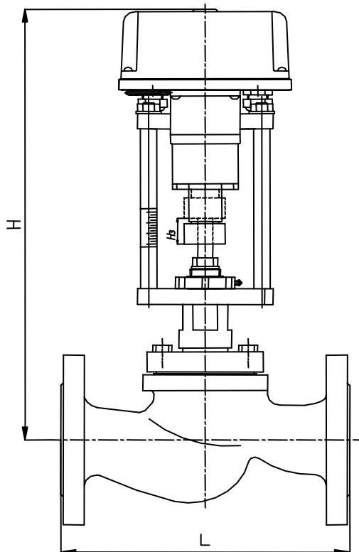
Рисунок 1. Габаритные установочные и присоединительные размеры клапана.
