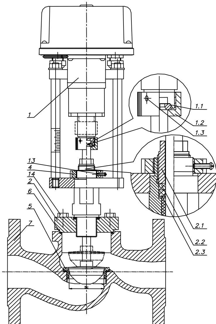
Рисунок 1 Общее устройство клапана КЗР 50/ХХ.Б-ХХ
