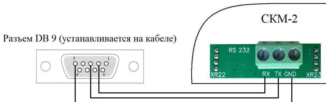
Рис. 5 Схема подключения счетчика к компьютеру
